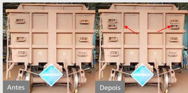
Figura 6: Instalação de linha adicional de drenos em 1.278 vagões do tipo GDU para melhor captação da água livre.
