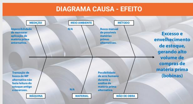
Figura 4: Diagrama de Ishikawa para o processo de ressuprimento.
